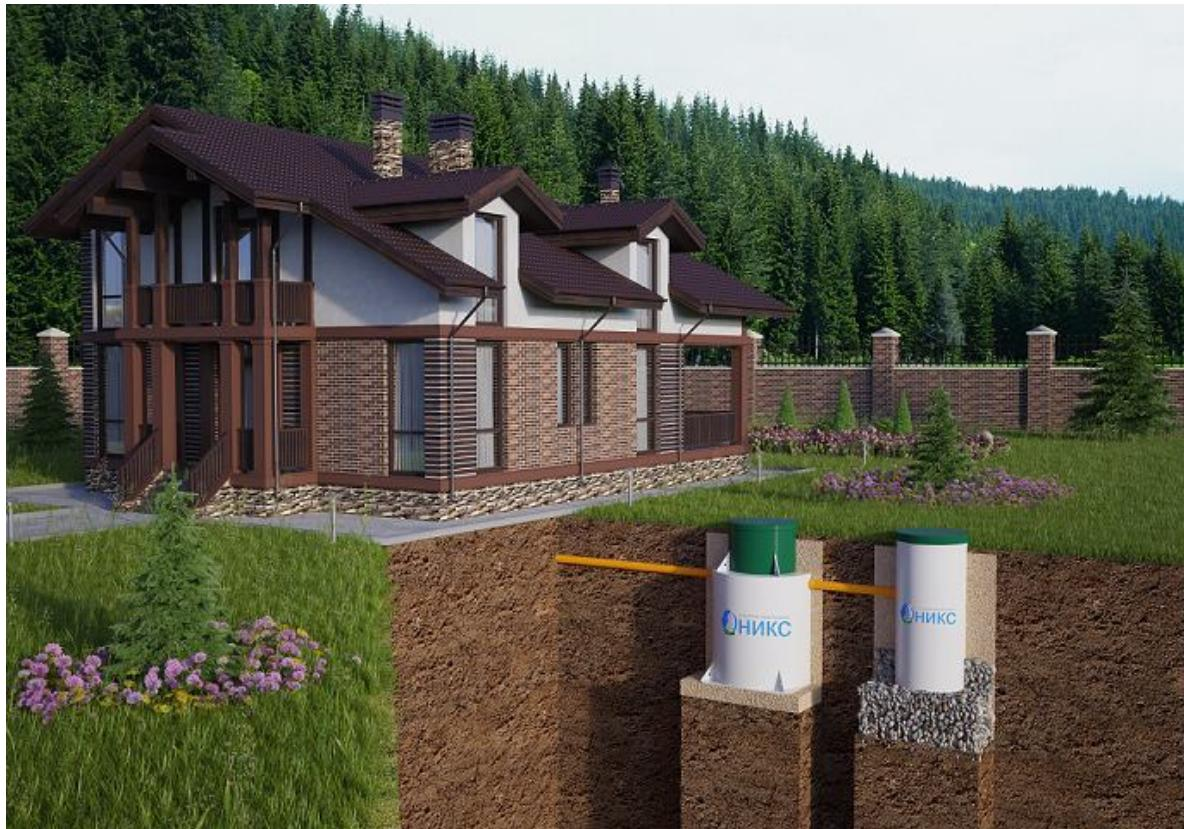
**Вариант 4:** Монтаж с отводом очищенных сточных вод в фильтрующую траншею. Подходит для хорошо впитывающих грунтов (песок, супесь) и низком уровне грунтовых вод.
