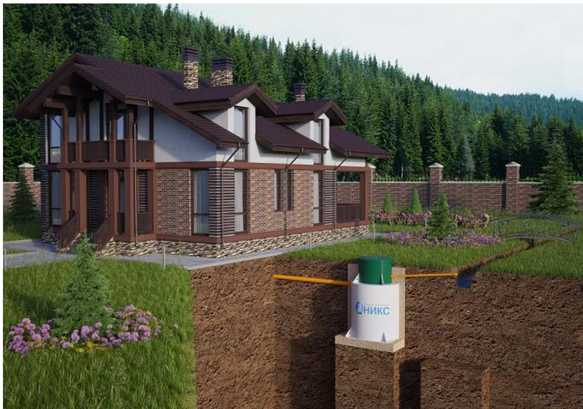
**Вариант 3:** Монтаж с отводом очищенных сточных вод в фильтрующий колодец. Подходит для хорошо поглащающих грунтов (песок, супесь) и низком уровне грунтовых вод.
