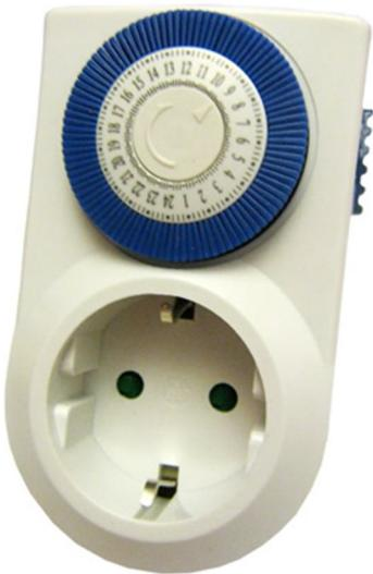
Настройка таймера. Таймер регулирует работу насоса подающего жидкость на распылитель и работает не постоянно, а 15 минут в час и 30 минут отдыхает. На таймере каждое деление соответствует 15 минутам, одно деление нажимаем, далее два пропускаем и так по кругу. Сбоку на корпусе переключатель устанавливаем в положение значка часов.
