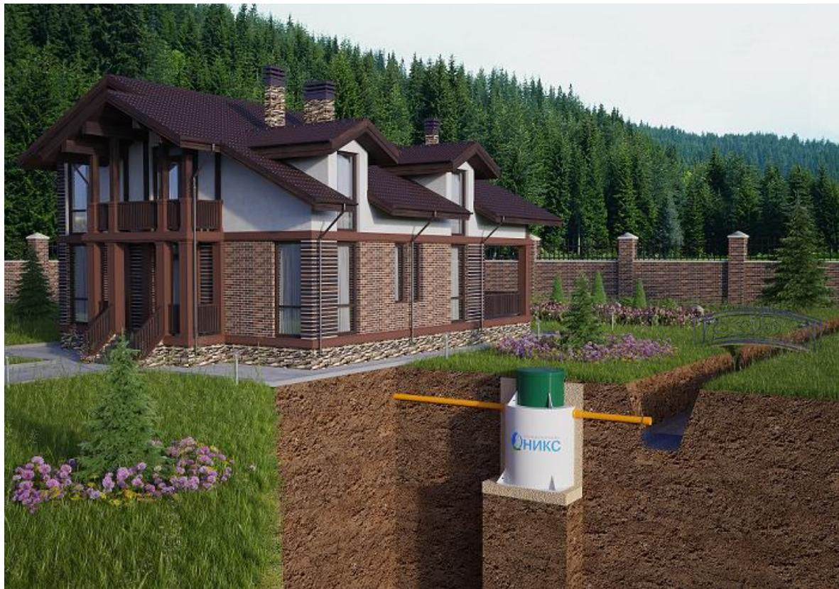
**Вариант 2:** Монтаж при принудительном отводе сточных вод в дренажную канаву.
